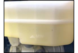
Remvloeistof reservoir, aan de zijkant kun je het niveau aflezen.
