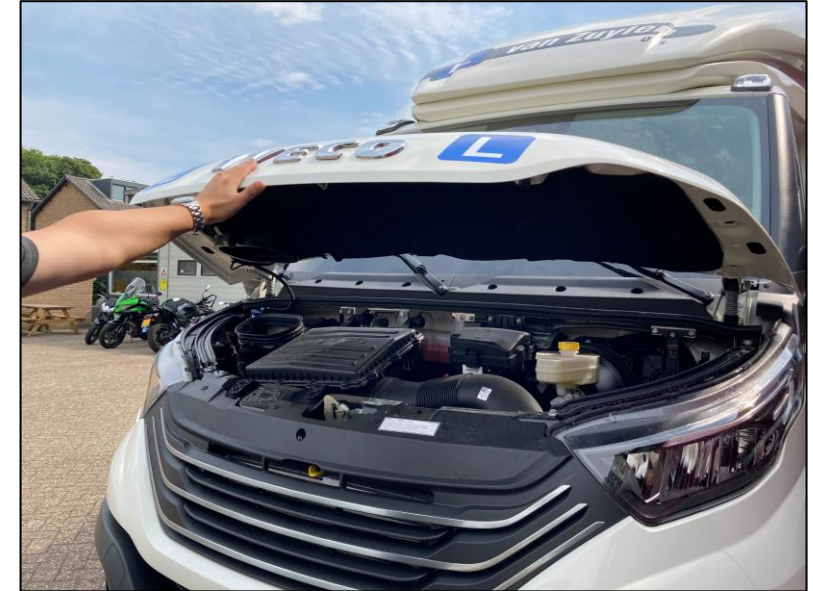
Duw deze rustig helemaal open, de motorkap blijft vanzelf openstaan.
