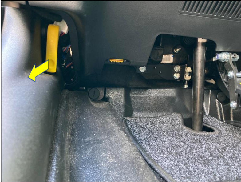
Open aan de bestuurderszijde het portier. Daar zit, rechts net naast de deurstijl, een (gele) hendel om de motorkap te ontgrendelen.
