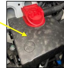
Pluspool van de accu, de accu zelf bevindt zich in de cabine onder de bestuurderstoel.
