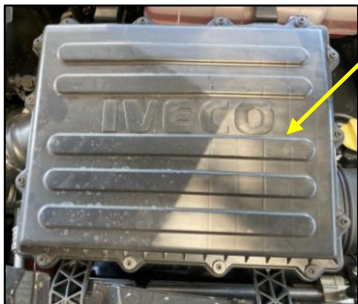
Luchtfilterhuis t.b.v. het luchtfilter voor de motor.
